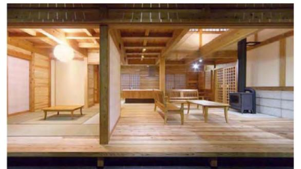
内観：土間から和室・リビングを見る。薪ストーブの廻は大谷石積みとし、切り捨てられる間伐材を燃料とする。家具は地元木工家により制作されたものを採用した。夏は、開放感のある空間で風通しがよく、エアコンなしで十分涼しい。冬は、太陽熱を床下に蓄熱し薪ストーブをなしでも15℃以上を保つ。
