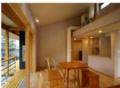
リビングの西側を見る OMソーラーシステムの送風機と下りダクト、頂側窓を見る。
