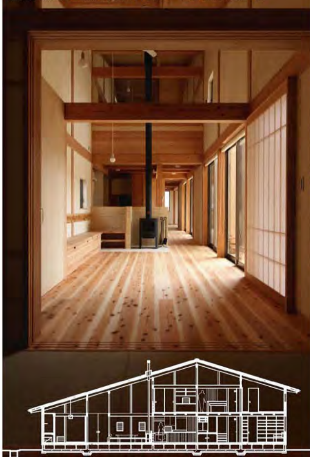
和室よりリビングをみる。南面の大きな開口部から日照が十分確保でき、は薪ストーブのみで家全体を暖房する。
