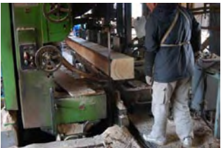
④半年自然乾燥してから製材する。木くずとともに甘い香りが漂い木の精気が感じられる。
